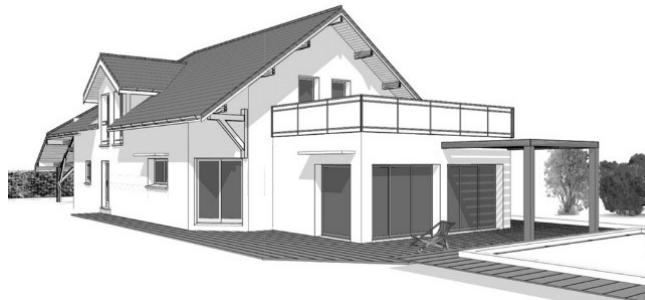
Illustration d'une toiture terrasse accessible et intégrée de façon accessoire à une construction dont la toiture principale est à pans.
